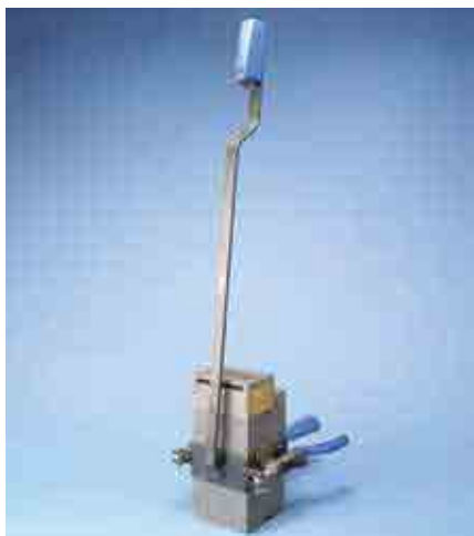
Molde clave de precio "H" Incluye marco de sujeción con mangos
