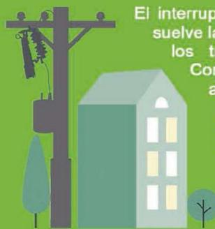
El interruptor de Restablecimiento VacuFuse II resuelve las molestas interrupciones que ocurren en los transformadores de distribución aérea. Como un interruptor monofásico de reinicio automático destinado para ser utilizado en los transformadores del sistema de distribución con voltajes primarios de 7.2 kv a 15.5Kv, reemplaza los fusibles en estos lugares. Cuando el interruptor de restablecimiento detecta falla, su cámara interruptiva en vacío se abrirá para interrumpir la corriente de falla.
