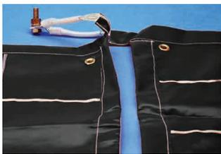
(Izquierda) Para unir mallas, simplemente se conectan las rejillas conductoras en las orejetas de conexión con el perno, la arandela y la tuerca que se incluyen con cada malla. Las orejetas están dotadas de tubo termocontráctil para aliviar el esfuerzo. (Derecha) Los pernos de bola pueden unir las mallas y conectarlas a las grapas del juego de puesta a tierra.
