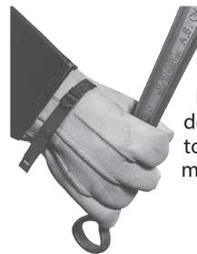
El mango bidireccional puede moverse hacia ambos lados (esto es útil cuando la persona se inclina debajo del nivel del pecho para manejar el polipasto). El tope redondeado en el extremo ayuda a mantener la mano en el mango
