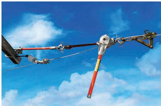
Permite colocar rápidamente el eslabón aislado en trabajos asistidos por el polipasto:
