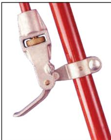
Con el mango posicionado como se muestra en la foto de arriba, la tuerca moleteada se puede girar para ajustar la pieza de agarre al tamaño exacto del cable.
