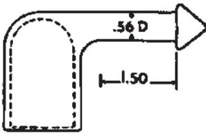
Cabezal de desconexión de 1/2"
