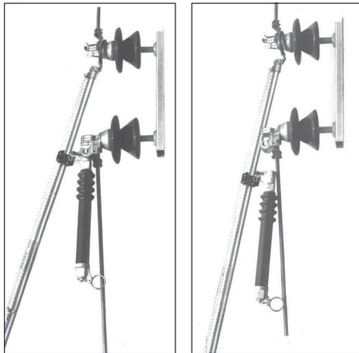
**Cómo retirar un fusible de potencia:** enganche la punta del portafusible en el ojo del extremo inferior invertido del portafusible. Levante el portafusibles de los muñones de contacto y baje el portador.
