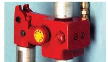
Con la perilla de control se selecciona la dirección. Atención: Al guardar la herramienta, asegúrese de eliminar la presión hidráulica girando la perilla a la posición Open.
