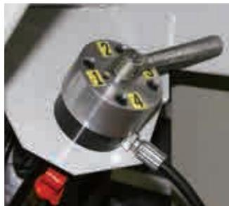
**SELECTOR DE ÚTIL CON VÁLVULA DE 4 VÍAS**
