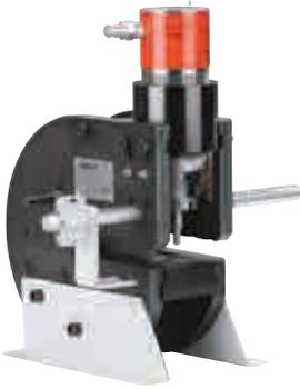
**PUNZONADORA HIDRÁULICA PARA BARRAS DE COBRE Y FLEXIBAR**
