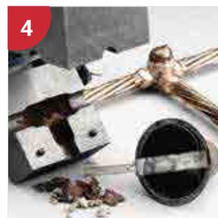
4 Abra el molde y retire el recipiente de acero gastado; no se requieren métodos especiales para desecharlo
