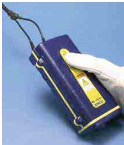
**Paso 4:** Accionar el botón de contacto y mantenerlo presionado. Abrir el molde después 10 segundos.
