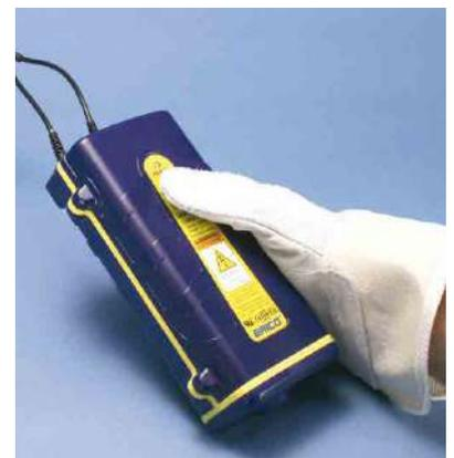
**PASO 4** Accionar el botón de contacto y mantenerlo presionado. Abrir el molde después de 10 segundos.
