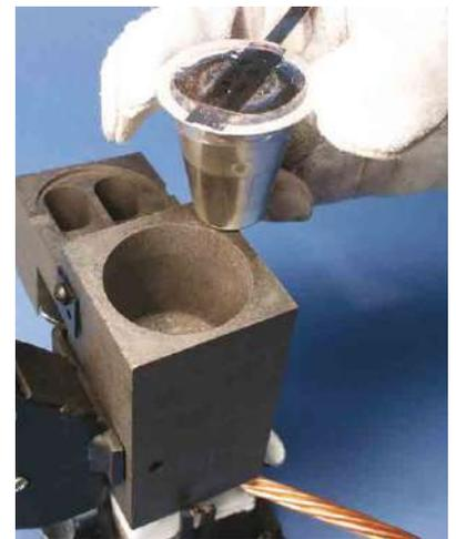
**PASO 1** Instalar las empaquetaduras y los conductores que soldar en el molde.
