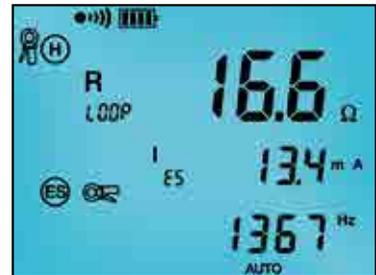
El método de doble pinza muestra la resistencia de conexión de la pinza, corriente de prueba y frecuencia.
